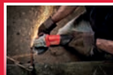
BIZTONSÁGI KUPLUNG AZ ESETLEGESEN FELLÉPŐ VISSZARÚGÁS EFFEKTUS ELKERÜLÉSÉRE
