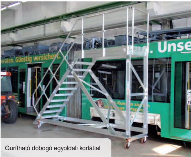
Gurítható szerelőállvány kinyitható korlátokkal
