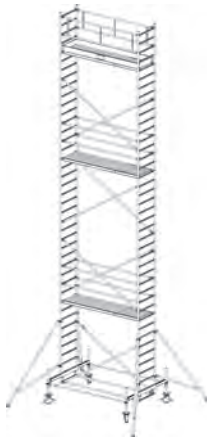
Munkamagasság: 11,40 m Állványmagasság: 10,40 m Állómagasság: 9,40 m
