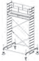
Munkamagasság: 5,40 m Állványmagasság: 4,40 m Állómagasság: 3,40 m
