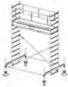
Munkamagasság: 4,40 m Állványmagasság: 3,40 m Állómagasság: 2,40 m
